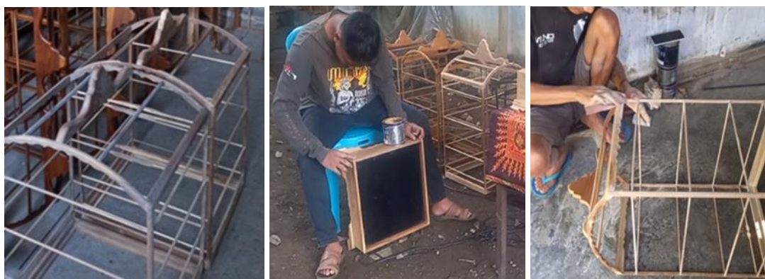
Gambar 1. Pemilihan sangkar burung, pendempulan, dan pengamplasan
