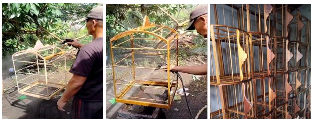
Gambar 2. Pengecatan awal, pengecatan akhir, dan hasil pengecatan
