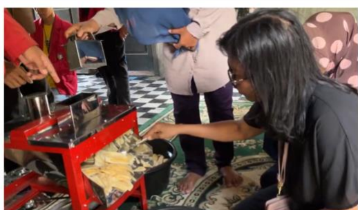
Gambar 14. Mesin rajang pisang dan singkong
