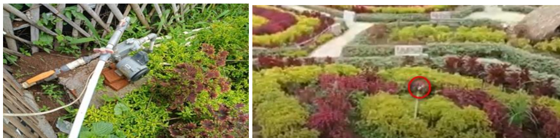
Gambar 6. Pengetesan alat penyiraman tanaman otomatis dengan pompa air dan sprinkler
