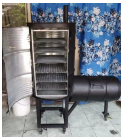
Gambar 4. Alat inovatif pengasapan ikan mujair
