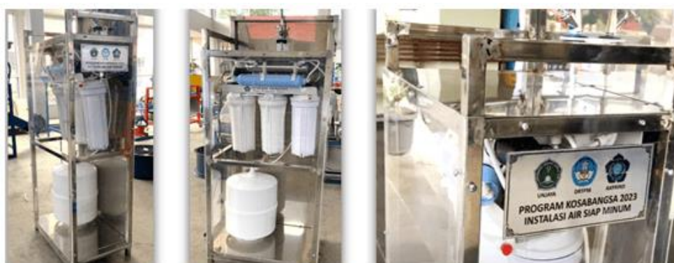
Gambar 1. TTG Mesin Pengolah Air Siap Minum
