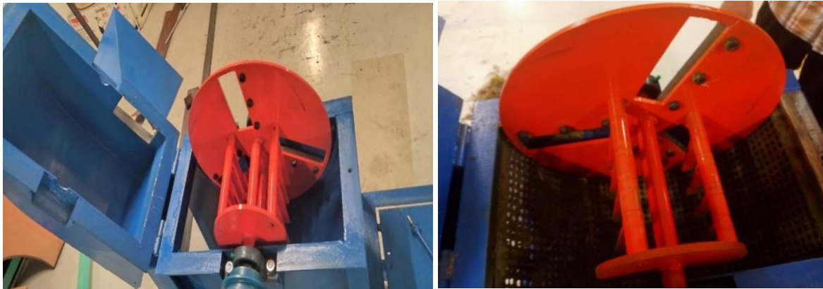
Gambar 4. Pisau pemotong yang perlu mendapat perhatian dan perawatan khusus
