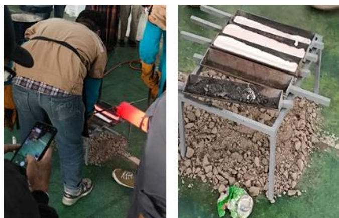
Gambar 8. Proses Pengecoran (Pencetakan)
