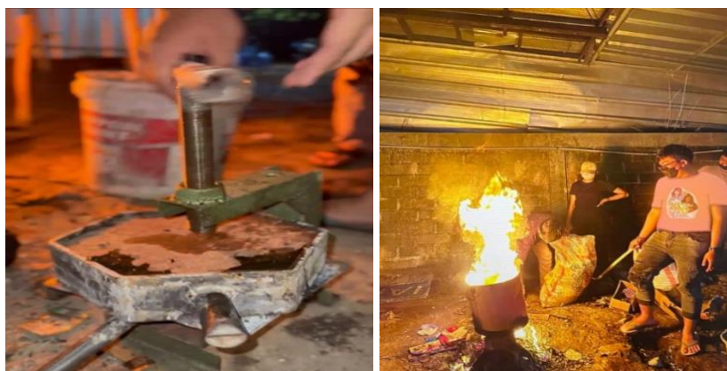
Gambar 1. Percobaan pembuatan paving block dari sampah plastik
