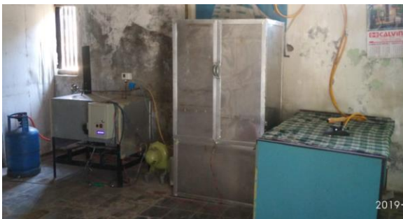
Gambar 2. Boiler setrika uap yang terintegrasi dengan pengering laundry
