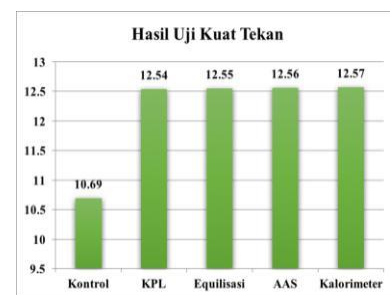
Gambar 3. Grafik Penambahan Limbah B3 Terhadap Kuat Tekanan Beton
